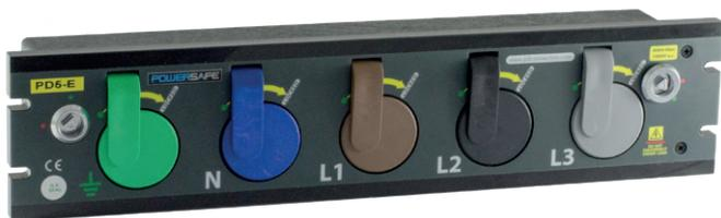
La PowerSAFE Box è un'unità di collegamento a per il generatore o il collegamento alla rete. L'ordine di collegamento e disinserimento viene predefinito per assicurare che i circuiti di sicurezza (PE+N) vengano collegati per primi e disinseriti per ultimi. Inoltre i collegamenti codificati impediscono la possibilità di contatti errati.
